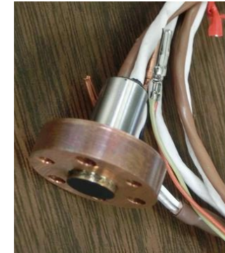
EFT-1 Heat shield Radiometer
