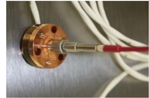
EFT-1 Heat shield Radiometer
